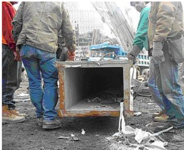
Figure 1-4. Perimeter column/spandrel assembly and floor structure. Структура сборок периферийных колонн/несущих стен и этажей.
